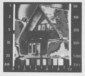
geeignet sind. Eine AGA Baudiagnose enthält eine Analyse gefundener und verdächtiger Schwachstellen und gegebenenfalls eine Empfehlung der zu treffenden Massnahme. Eingeschlossen ist die für jede Fehlerstelle angefertigte Photodokumentation.
