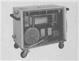
Die mikrobiologische Prüfung der Zuluft erfolgt zwei bis drei Tage nach der Desinfektion des Kanalnetzes. So kann man feststellen, ob in der eingeführten Luft noch aktive Keime vorhanden sind. Je Messstelle ist mindestens 1 m³ angesaugte Luft in unmittelbar aufeinanderfolgenden Probenahmen zu untersuchen. Der Keimpegel soll fünf Keime/m³ Luft bei den Luftauslässen mit schwebstoffiltrierter Luft nicht überschreiten.
