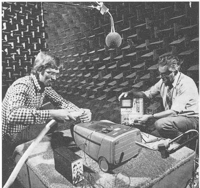
Inneres des schalltoten Raumes, in dem Schallmessungen an einem Staubsauger durchgeführt werden. Wände, Fussboden und Decke sind mit speziell profilierten Blöcken aus einem Material mit hohem Schallschluckgrad verkleidet
