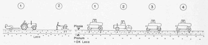
Bild 11. Arbeitsgänge beim Verdichten von Kiessand I über der Leca-Schüttung
