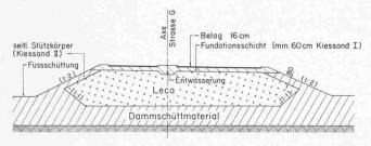
Bild 7. Dammquerschnitt im Bereich der Leca-Schüttung
