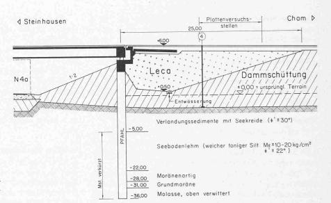
Bild 4. Widerlagerbereich Seite Cham mit der Ausdehnung der Leca-Schüttung, dem Setzungspegel und dem Piezometer Nr. (4)
