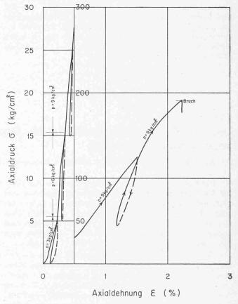
Bild 6. Spannungs-Dehnungsdiagramm eines Mergels mit 60 % CaCO<sub>3</sub> (Bohrung B 3, Tiefe 15,5 m ab OK Terrain)
