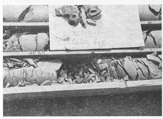
Bild 4. Stark geklüfteter Mergel, entspricht lithologisch dem Material, dessen Verformungsverhalten in Bild 6 dargestellt ist
