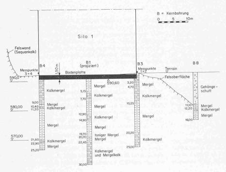
Bild 2. Geotechnischer Schnitt
