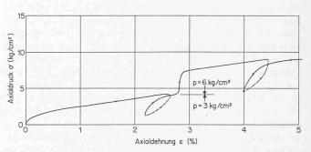
Bild 5. Spannungs-Dehnungsdiagramm eines Mergels mit 45% CaCO<sub>3</sub> (Bohrung B 3, Tiefe 2,0 m ab OK Terrain)
