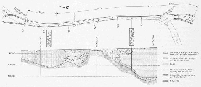
Bild 1 und 2. Situation (oben) und geologisches Längenprofil (10 fach überhöht)
