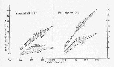
Bild 12. Maximal- und Minimalwerte der mittleren Mantelreibung unter Berücksichtigung der insgesamt fünf Belastungsvorgänge in Abhängigkeit von der aufgebrachten Pfahlbelastung
