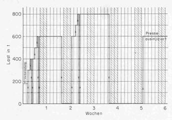
Bild 8. Belastungsschema, gültig für beide Versuchspfähle. Da Belasten und Entlasten erfolgte immer in Laststufen von 100 t
