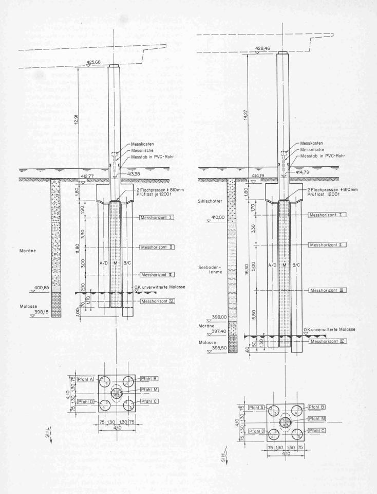
Bild 6. Pfeiler 111 West mit Pfahlanordnung und schematisch eingetragener Messeinrichtung
