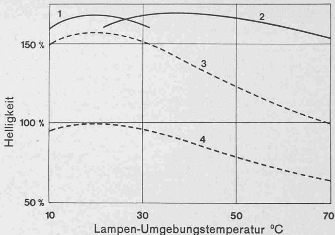
Das Diagramm zeigt den über einen weiten Temperaturbereich möglichen Helligkeitszuwachs: 1 LUMILUX, 2 LUMILUX «In», 3 bisherige Standard-Lichtfarben, 4 bisherige de Luxe-Lichtfarben.
