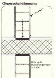
Pronouvo 1073 vermag grosse Lasten zu übertragen und ist auch hochbelastet ein wirkungsvolles Körperschall-Isoliermittel.
