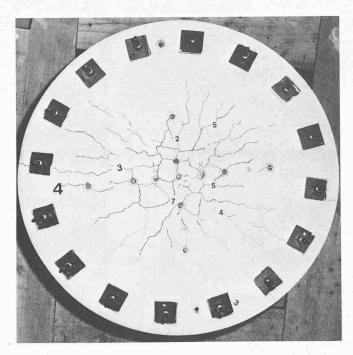
Bild 7. Rissbild unter Nutzlast (P = 138 kN) bei Leichtbeton. Rissbreiten in  $^{1}/_{100}$  mm
