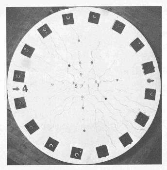
Bild 6. Rissbild unter Nutzlast (P = 138 kN) bei Normalbeton. Rissbreiten in  $^{1}\!/_{100}$  mm
