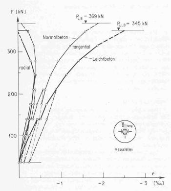
Bild 5. Last-Stauchungsdiagramme des Betons unmittelbar neben Stütze
