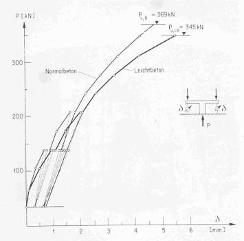
Bild 3. Last-Durchbiegungskurven des Plattenrandes
