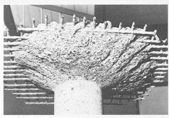
Bild 11. Freigelegter Durchstanzkegel bei Leichtbeton. Bruchfläche immer durch die Zuschlagstoffe
