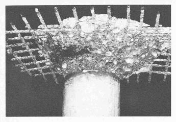
Bild 10. Freigelegter Durchstanzkegel bei Normalbeton. Bruchfläche teils entlang der Korngrenzen, teils durch die Körner hindurch
