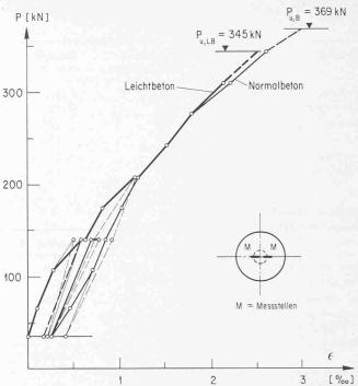
Bild 4. Last-Dehnungsdiagramme der Biegearmierung der obersten Lage
