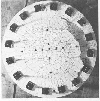
Bild 9. Rissbild im Bruchzustand ( $P_{\rm u,LB}=345\,{\rm kN}$ ) bei Leichtbeton
