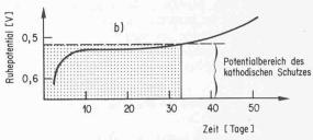
Bild 2. Zeitlicher Verlauf des Ruhepotentials unter Immersionsbedingungen
