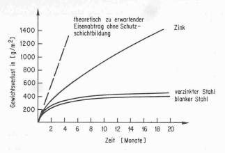
Bild 3. Das Korrosionsverhalten von blankem und feuerverzinktem Stahl bzw. von Reinzink in schnell fliessendem Grundwasser (nach Böhni [6])
