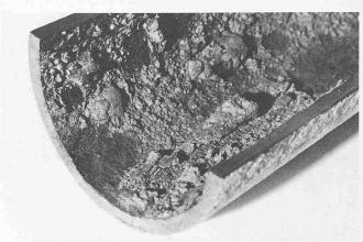
Bild 4. Lokaler Korrosionsangriff infolge von Makroelementbildung («Rostpusteln») in einer feuerverzinkten Wasserleitung
