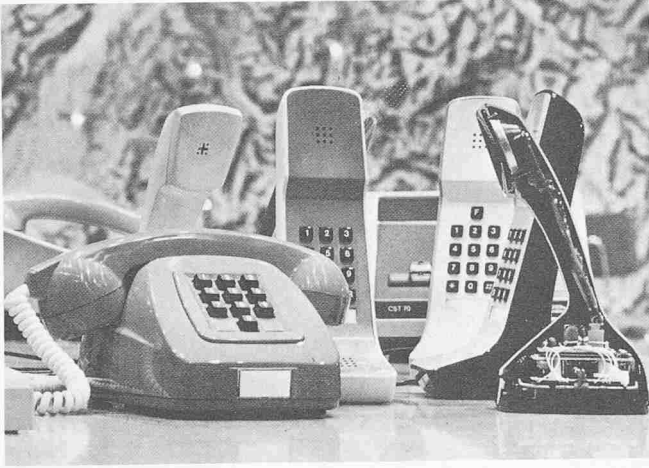
Eine Auswahl neuer, farbiger Telephonapparate. Links das Modell 70, daneben in der Mitte und rechts «unkonventionelle» Telephonapparate, die Hörer, Mikrophon und Wähleinrichtung im Handapparat enthalten
