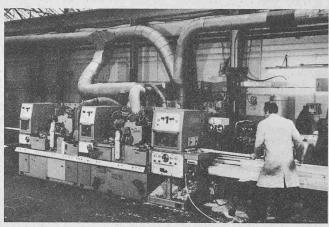
Die neue Holzbearbeitungsmaschine FBN 230 der Firma Wadkin bearbeitet dünnes Holz mit Geschwindigkeiten bis zu 100 m/Min.
