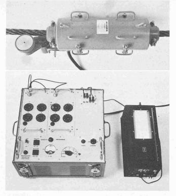
Defectoscop. Im Jahre 1956 wurden mit diesen Geräten die ersten magnetinduktiven Seilprüfungen in der Schweiz durchgeführt. Zum «Defectoscop» (oben) gehören ein Verstärker und ein Schreiber (unten). Zur Stromversorgung wurden sechs Akkumulatoren benötigt
