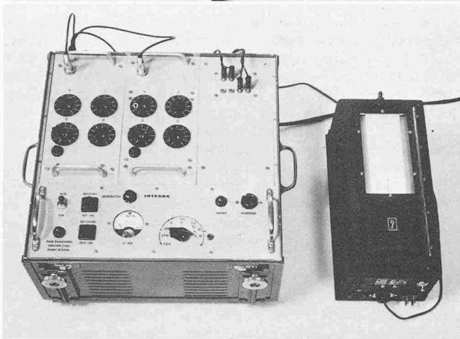
Defectoscop. Im Jahre 1956 wurden mit diesen Geräten die ersten magnetinduktiven Seilprüfungen in der Schweiz durchgeführt. Zum «Defectoscop» (oben) gehören ein Verstärker und ein Schreiber (unten). Zur Stromversorgung wurden sechs Akkumulatoren benötigt
