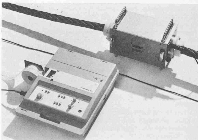
Kleinprüfgerät. EAV-typengeprüftes Gerät, das für betriebsinterne Kontrollen, durchgeföhr von den Seilbahnunternehmen, zugelassen ist
