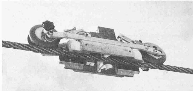
Das prüfbereite Defectoscop. Im Jahre 1969 wurde für die Tragseilprüfung eine pneumatische Schliess- und Abhebevorrichtung gebaut, wodurch sich die manuellen Montage- und Demontagearbeiten, die zu einer Stützenüberfahrt nötig waren, ausschalten liessen
