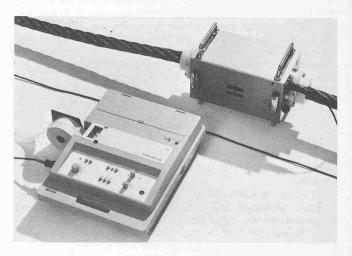
Kleinprüfgerät. EAV-typengeprüftes Gerät, das für betriebsinterne Kontrollen, durchgeführt von den Seilbahnunternehmen, zugelassen ist
