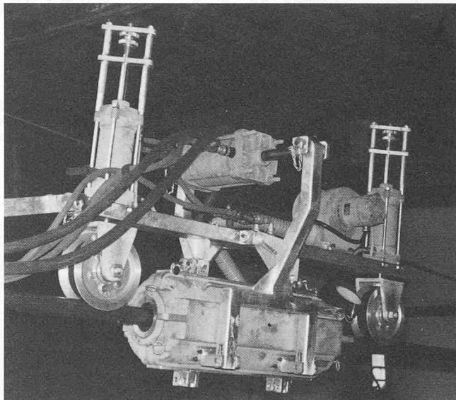
Permanentmagnetisches Seilprüfgerät. Das EMPA-Seilprüfgerät P. M. mit geöffneter Messspule. In dieser Position wird die Stütze überfahren
