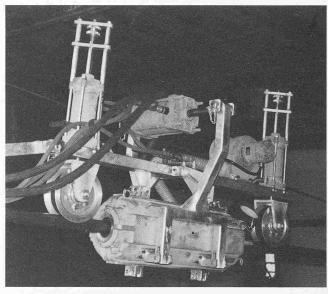
Permanentmagnetisches Seilprüfgerät. Das EMPA-Seilprüfgerät P. M. mit geöffneter Messspule. In dieser Position wird die Stütze überfahren
