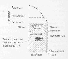
Bild 2. Schematische Darstellung von Wärmeverteilung, Wärmefluss und Spannungen in einem Brennelement
