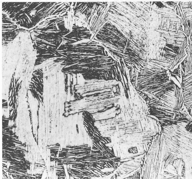
Bild 2. Schliffbilder von Ti-6Al-V. Links: feinkörniger Zustand. Rechts: grobkörniger Zustand
