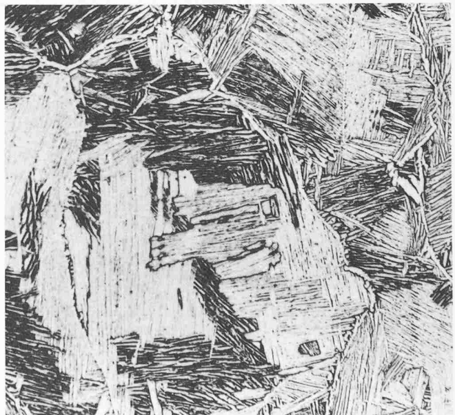
Bild 2. Schliiffbilder von Ti-6Al-V. Links: feinkörniger Zustand. Rechts: grobkörniger Zustand
