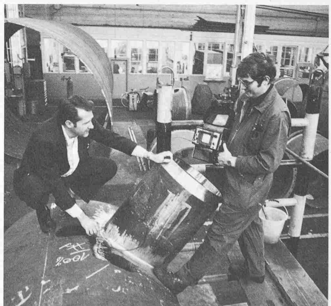
Bild 16. Ultraschallprüfung durch einen Sachvertändigen des SVDB einer Stutzenschweißung an einem Wärmeaustauschermantel für das Kernkraftwerk Leibstadt. Der Prüfer (links) führt mit der rechten Hand den Prüfkopf und beobachtet den Bildschirm des Prüfgerätes
