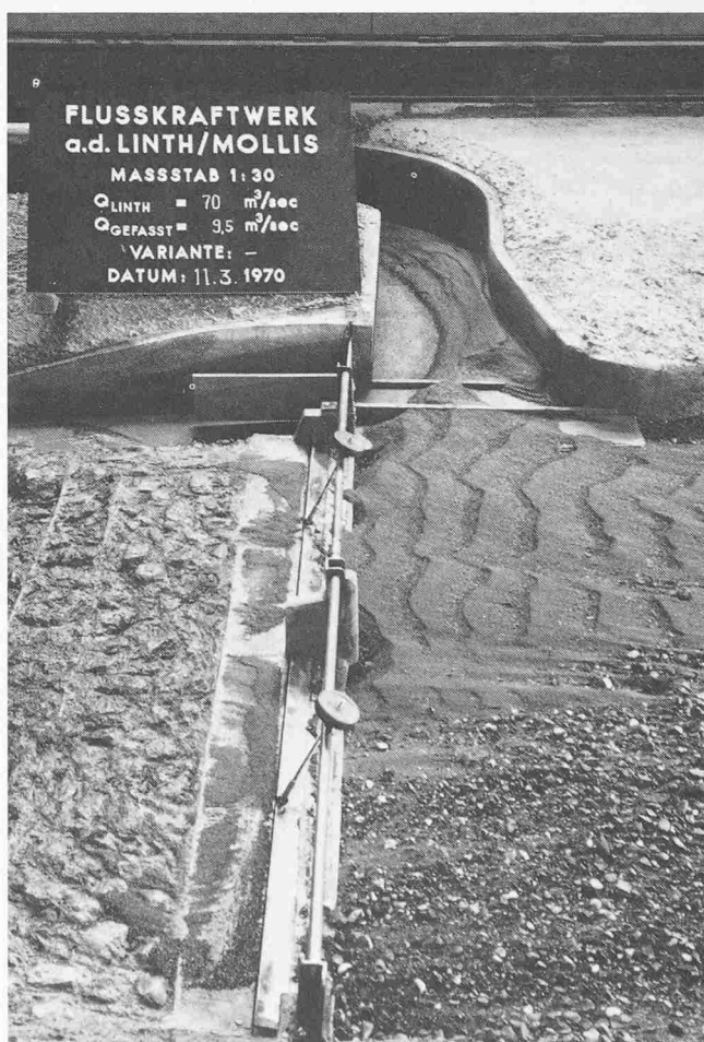
Bild 6. Bei bestehender Fassungsanlage starkes Eindringen von Geschiebe
