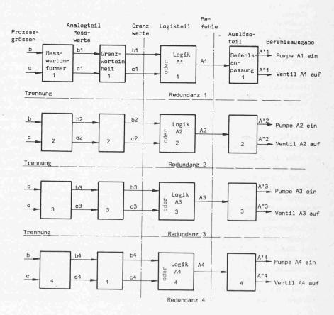
Bild 2. Reaktorschutzlogik für Reaktorkühlung
