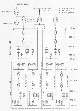
Bild 5. Einpoliges Schema der Eigenbedarfsanlage
