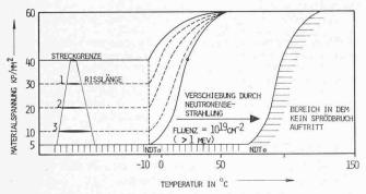
Bild 4. Erhöhung der Sprödbruchübergangstemperatur durch Neutronenbestrahlung. Sprödbruchdiagramm nach Pellini
