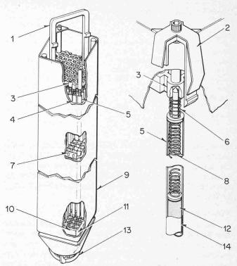
Bild 5a (oben). SWR-Brennelement
