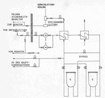
Bild 11. Reaktorwasserreinigungsanlage
