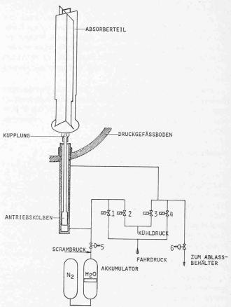
Bild 7. Steuerstabantriebssystem  $\begin{bmatrix}
