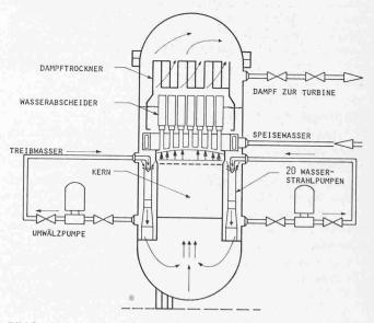
Bild 8. Kühlmittelumwälzung mit Wasserstrahlpumpen
