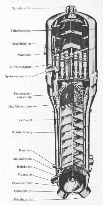
Bild 9. Dampferzeuger für das Kernkraftwerk Gösgen
