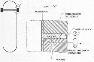
Bild 3. Dichtung des Reaktordeckelflansches mit Leckageüberwachung
