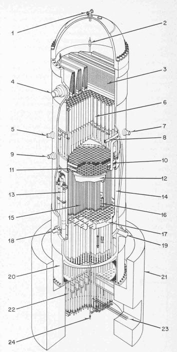
Bild 2. Druckgefäss mit Einbauten des Siedewasserreaktors
