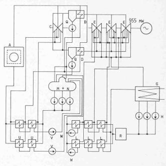
Bild 10. Kreislaufschema des Kernkraftwerkes Leibstadt
