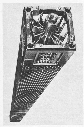
Bild 6. DWR-Brennelement mit Fingerregelstab
