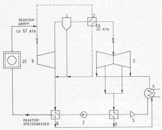
Bild 1. Arbeitsmittelkreislauf einer Nassdampfturbine, stark vereinfacht
