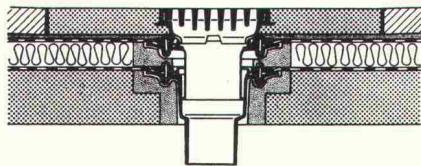
Flachdachablauf Guss zweiteilig mit Kugelrost, Isolierring, Isolierkörper, Distanzringe 25+35 mm Höhe, auch mit Flachrosten rund oder quadratisch lieferbar.
