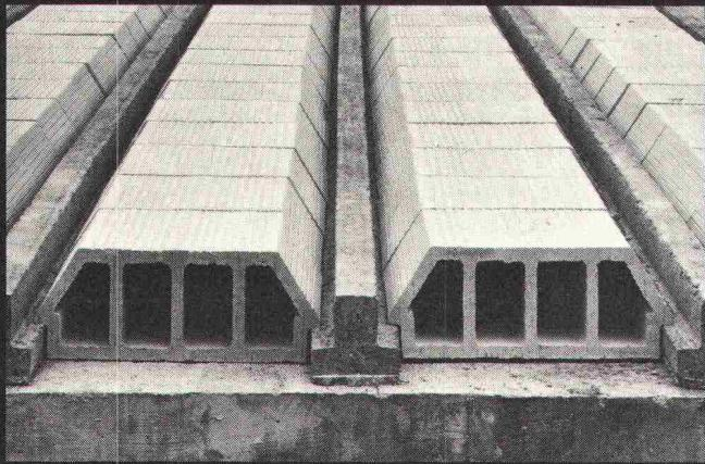
PRENORM ist ein vielseitig verwendbares Deckensystem aus vorgespannten, armierten Betonbalken und dazwischenliegenden Ton-Hohlkörpern. Die Balken bestehen entweder ganz aus Beton oder aus Beton mit einem Tonschuh. Nach dem Verlegen der Balken und der Ton-Hohlkörper wird der Überbeton eingebracht. Durch die Verwendung verschieden starker Ton-Hohlkörper kann die Deckenstärke und somit die zulässige Belastung der Decke zwischen 300 kg/m<sup>2</sup> und 800 kg/m<sup>2</sup> gewählt werden.
