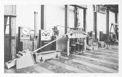
Eine zweite Anlage, die auch der Ermüdungsprüfung umgelenkter Stahlseile dient, steht ebenfalls zur Verfügung. Sie erlaubt Kräfte bis zu  $P_0 \cong 6,0$  MN bei Kraftamplituden von etwa  $\triangle P \cong 1,0$  MN. Die Seillänge ist allerdings kürzer als bei der in Bild 1 dargestellten Anlage und beträgt nur etwa l = 6000 mm.
