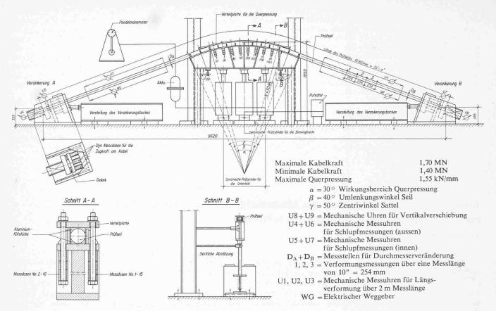
Bild 1. Schematische Darstellung der Versuchseinrichtung zur Durchführung von Ermüdungsversuchen an umgelenkten Stahlseilen (Masse in mm)
