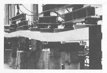
poutres préfabriquées rendues monolithiques après la pose. La redistribution des moments, la fissuration et l'évolution des déformations y sont étudiées sur des modèles de grandes dimensions.
