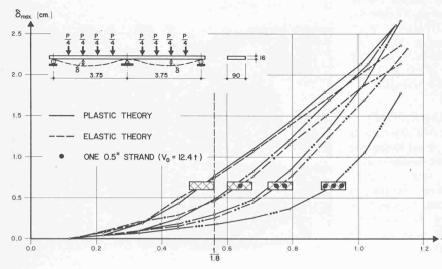
Fig. 4. Flèche maximale  $\delta_{\rm max}$  en fonction de P/Pr Maximal deflection  $\delta_{\rm max}$  in function of P/Pr
