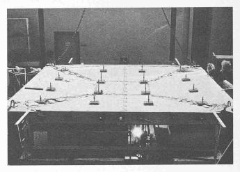
Bild 2. Versuchsanlage «Vorgespannte Platten» Test rig "prestressed slabs"
