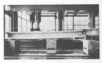
Bild 3. Versuchsanlage «Teilweise Vorspannung» Test rig "partial prestressing"
