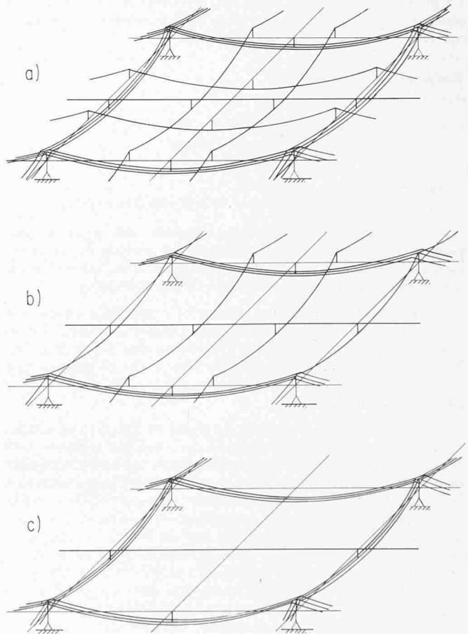
Bild 1. Verschiedene Möglichkeiten für die Anordnung der Spannglieder in Flachdecken
