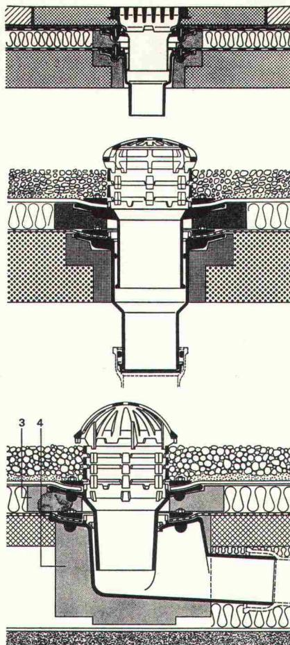
Flachdachablauf Guss zweiteilig mit Kugelrost, Isolierring, Isolierkörper, Distanzringe 25+35 mm Höhe, auch mit Flachrosten rund oder quadratisch lieferbar.
