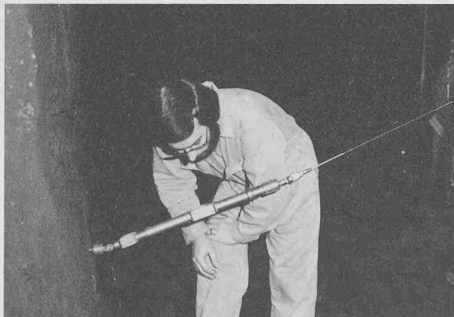
Präzisions-Längenmessgerät Distometer ISETH.
