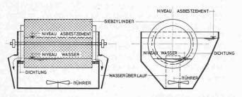
Bild 2. Stoffkasten und Siebzylinder. Oben: Grundriss. Unten: Längsschnitt und Querschnitt (rechts)
