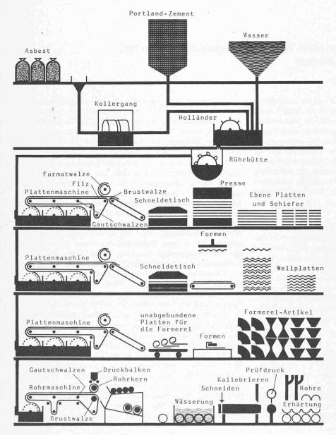
Bild 1. Fabrikationsschema
