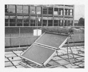
temperatur ab. Ausschlaggebend für die Qualität des Kollektors ist die Güte der Isolation gegen Wärmeleitungs- und Abstrahlungsverluste, die als k-Wert spezifiziert wird. Dieser lässt sich aus den gemessenen Wirkungsgraden bei verschiedenen Speichertemperaturen und Einstrahlungsverhältnissen eindeutig berechnen.
