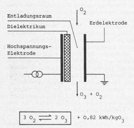
Schematische Darstellung einer Elementarzelle in ihrer einfachsten Form. Reiner Sauerstoff oder Luft strömt zwischen zwei Elektroden, die durch ein Dielektrikum getrennt sind. Durch die angelegte Spannung werden die Sauerstoffmoleküle in einen angeregten Zustand versetzt, und ein Teil dieser Moleküle spaltet sich in die Atome auf. Diese bilden anschliessend mit den Sauerstoffmolekülen die dreiatomige Modifikation O<sub>3</sub>
