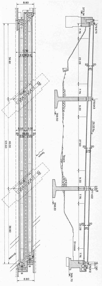
Bild 3. Längsschnitt und Grundriss der neuen Brücke
