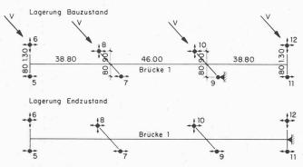
Bild 7. Lagerung einer Brücke vor und nach dem Einschieben. Die Pfeile geben die Bewegungsmöglichkeiten an, V die Verschieberichtung
