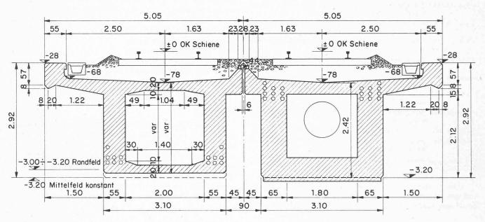
Bild 4. Querschnitt der neuen Brücke
