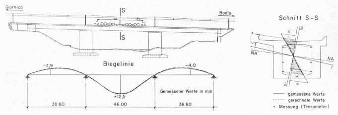
Bild 6. Belastungsprobe. Biegelinie und Spannungen in Systemmitte bei Belastung mit einer Lokomotive Ae 8/14 (246 t) in Mittelöffnung.  $E_h = 420 \text{ t/cm}^2$
