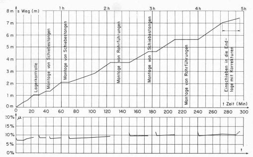
Bild 9. Zeit-Weg-Reibungsdiagramm nach Angaben der Firma Losinger.  $\mu$  = Haft- und Gleitreibungskoeffizient (Mittel der auf den vier Verschubbahnen gemessenen Werte)
