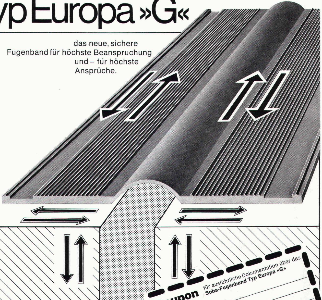
Das Soba-Fugenband Typ Europa «G» kann in endlosen Längen hergestellt (vulkanisiert) werden. Zusammensetzungen (Nahtverbindungen) auf der Baustelle sind mit Spezialformen ohne weiteres möglich (Ausführung durch unsere geschulten Fachkräfte).
