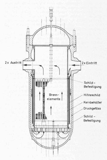
Bild I. Schema eines Leichtwasserreaktors und seines Kühlwasserdurchflusses
