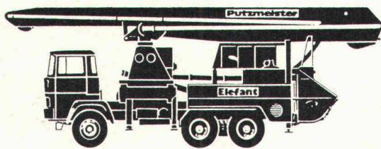
PUTZMEISTER Geräte werden als Autopumpen, Anhängerpumpen und stationäre Pumpen mit Leistungen zwischen 20 und 145 m<sup>3</sup>/h und Pumpendrücken zwischen 34 und 260 bar gebaut. Konstruktives Charakteristikum ist das pat. PUTZMEISTER Rüsselsystem mit der einzigartigen Rohrweiche, die dank einem selbst nachstellenden Automatikring die Trennstelle zwischen Rohrleitung und Betonförderzylinder hermetisch abdichtet.
