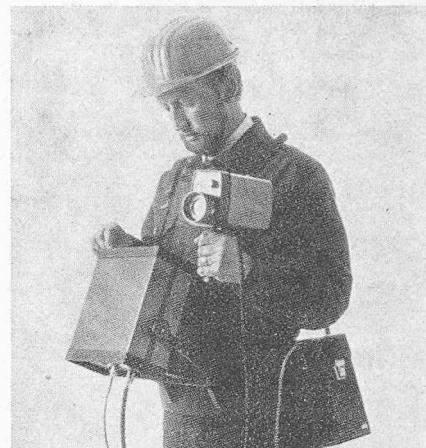
Bild 1 (links). Transformator mit fehlerhaftem Leitungsanschluss. Der Fehler ist an der übermässigen Erwärmung des Isolators zu erkennen (helle Bildstelle). – Bild 2 (Mitte). Emissionsvermögen eines schwarzen Körpers als Funktion der Wellenlänge bei verschiedenen Temperaturen (Plancksche Kurven). – Bild 3 (rechts). Tragbare Messausrüstung für thermographische Aufnahmen
