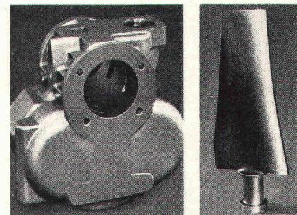
scheiden zugunsten von Leichtmetallguß. Einige Legierungen erreichen die Festigkeit von normalem Baustahl bei dreimal leichterem Gewicht. Stückgewichte von über einer Tonne, verschiedene Legierungen zur Wahl, Materialprüfungen mit Röntgenanlage, das sind einige Aspekte zugunsten der SLM als leistungsfähige Leichtmetallgießerei.
