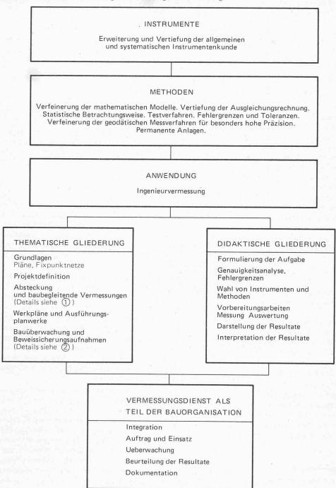
Es ist naheliegend, dass diese Ursachen zugleich mit den wichtigsten Gesichtspunkten beim Einsatz der Vermessung im Ingenieurwesen identisch sind. Deshalb werden zu einzelnen davon einige Ausführungen beigefügt.
