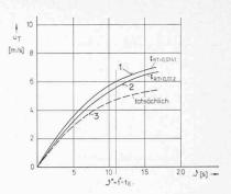
Bild 10. Tatsächlicher Geschwindigkeitsverlauf der Luftströmung im Tunnel der U-Bahn Hamburg bei Fahrt eines 4-DTW-1-Zuges in einer eingleisigen Tunnelröhre
