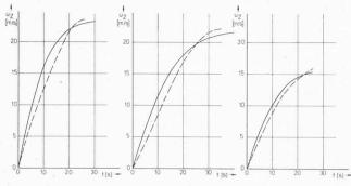
Bild 1. Verschiedene U-Bahn-Fahrdiagramme bis zum Erreichen der maximalen Zuggeschwindigkeit  $u_Z^*$  (gestrichelte Linien) und Näherungslösung durch die Funktion  $u_Z=u_Z^*$  tan h ( $2t/t^*$ ) (ausgezogene Linien)
