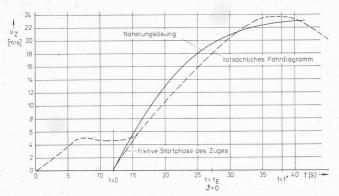
Bild 6. Tatsächliches (gestrichelte Linie) und angenähertes (ausgezogene Linie) Fahrdiagramm der U-Bahn Wien sowie Festlegung der fiktiven Startzeitmarke t=0 zur Berechnung
