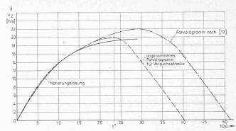
Bild 3. Aus in [13] für die U-Bahn München angegebenem Fahrdiagramm (strichpunktierte Linie) abgeleitetes Fahrdiagramm für die Versuchsstrecke (gestrichelte Linie) und Näherungslösung (ausgezogene Linie)
