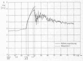
Bild 4. Zeitlicher Geschwindigkeitsverlauf der Luftströmung in einer eingleisigen Tunnelröhre der Münchner U-Bahn bei Fahrt eines 6-Wagen-Zuges
