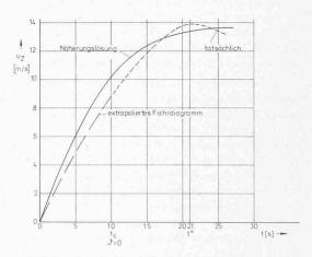
Bild 9. Tatsächliches (kurz gestrichelte Linie), auf den Startzeitpunkt extrapoliertes (lange gestrichelte Linie) und angenähertes (ausgezogene Linie) Fahrdiagramm der U-Bahn Hamburg
