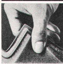
Sie bauen Betontanks gemäss den TTV (Techn. Tankvorschriften). **Wir** kleiden die Tanks mit einer seit 15 Jahren bewährten PVC-Doppelfolie aus. Versuchssprengungen mit dem Bundesamt für Zivilschutz bewiesen, dass unser Auskleidungen selbst nach Zerstörung des Betons dicht hielten. Unser System ist EMPA-geprüft und vom Eidg. Amt für Umweltschutz bewilligt. Beton ist auf die
