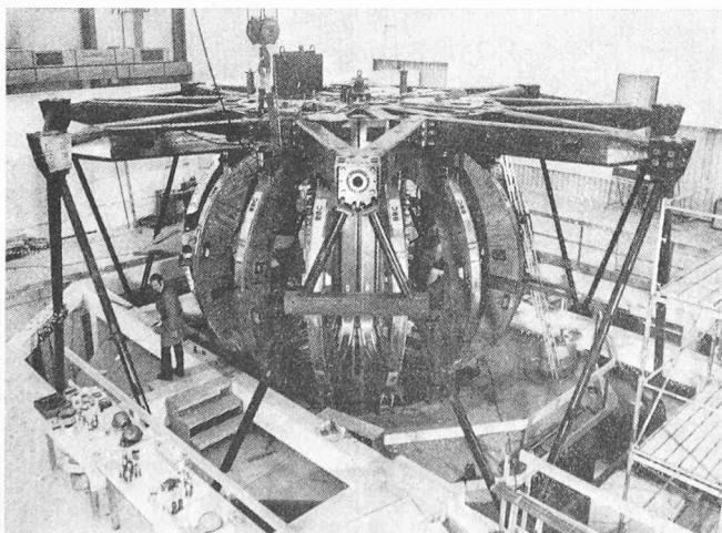
die Wände des Vakuumgefäßes treffen und dort Verunreinigungen auslösen, sollen hier mit Hilfe einer speziellen Magnetfeldanordnung die verlorengegangenen Plasmateilchen in separate Divertorkammern gelenkt werden. Dort werden sie neutralisiert und abgepumpt.
