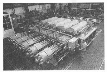
Bild 6. Sekundärkompressor 3166 at von heute
