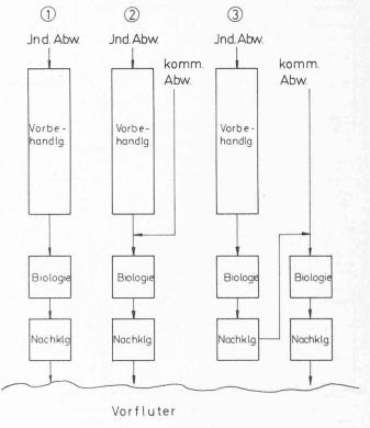
Bild 1. Kombinationsmöglichkeiten von Industrie- und Kommunalabwässer
