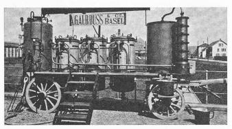
Bild 3. Fahrbare Obstsaft-Eindampfanlage mit Brüdenverdichtung aus dem Jahre 1933
