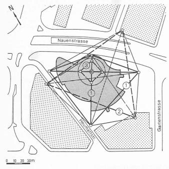
Bild 2. Triangulationsnetz der einzelnen Absteckungsphasen
