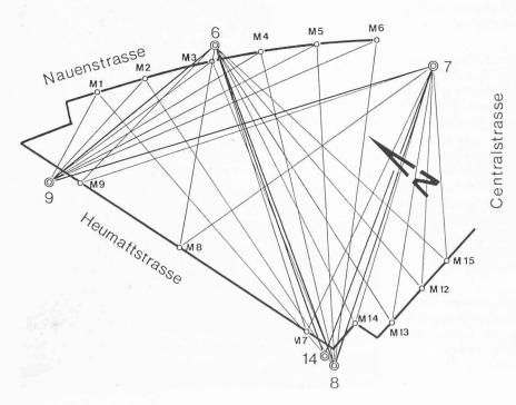
Bild 3. Kontrolle der Baugrube und Hauptvermessung für Umschliessungsmauer-Beobachtungen
