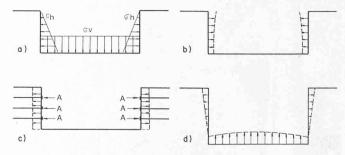
Bild 5. Verformungen der Baugrube. a) Spannungszustand vor Aushub, b) Verformung der Baugrube infolge Wegfall von  $\sigma_h$ , c) Verformung der Baugrube infolge Verankerung A, d) Verformung der Baugrube infolge Wegfall von  $\sigma_v$
