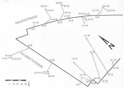
war es ratsam, den Bauvorgang vermessungstechnisch zu überwachen. Zu diesem Zweck wurden auf der Frontseite die Messmarken M1-M9 und an der Giebelwand die Messmarken M12-M15 versetzt. Die Punkte wurden in regelmässigen Abständen vermessen.
