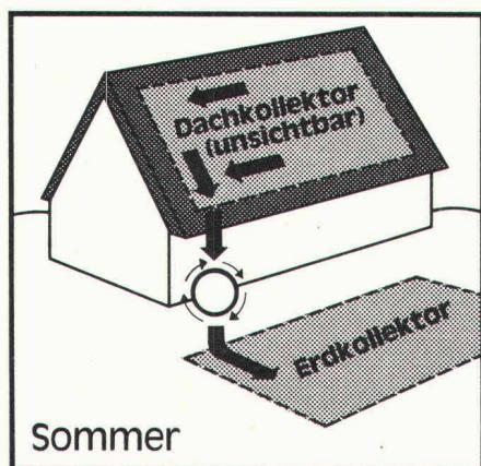
Bei Sonnenschein, warmer Temperatur oder mildem Regen nimmt der Dachkollektor Wärme auf, verlagert sie in den Erdkollektor zur Speicherung.
