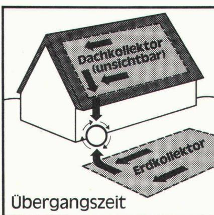
Wärmepumpe in Betrieb bei Sonnenschein in der Übergangszeit. Die Wärme wird aus dem Dachkollektor und teilweise dem Erdkollektor entzogen.
