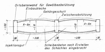
Bild 3. Grundriss der Betonscheibe
