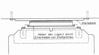
Bild 6. Neotopflager für grosse Horizontalverschiebungen
