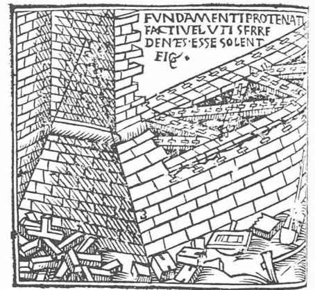
Fachwerkartige Versteifung von Stadtmaueranlagen. Aus M. Vitruvius «De architectura libri decem», Lyon, 1523
