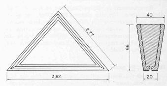
Bild 7. Schalungselmente für den Trägerrost
