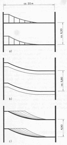
Bild 1. Tragkonstruktion für Grossauditorium. 1a: Amphitheater auf ebene Decke aufgeständert. 1b: Trägerdecke der Fläche angepasst. 1c: Gekrümmte Decke als Flächentragwerk wirkend
