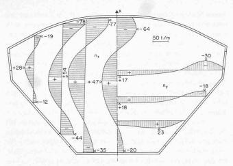
Bild 4. Verlauf der Membrankräfte in der Auditoriumsschale
