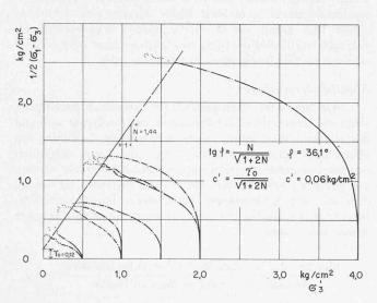
Bild 3. Triaxialversuche an Seekreide
