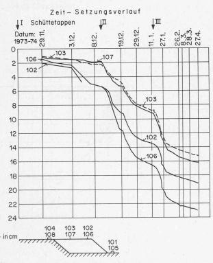
Bild 6. Versuchsschüttung La Neuveville. Zeit-Setzungsverlauf
