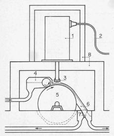
Bild 3. Prinzip der Klärschlammhygienisierung mit Elektronen. 1 Elektronenbeschleuniger, 2 Hochspannungskabel, 3 Scanner-System, 4 Schlammdosierung, 5 Förderwalze, 6 Schlammauslauf, 7 Umsteuerklappe, 8 Abschirmung
