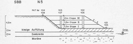
Bild 5. Versuchsschüttung La Neuveville. Schüttetappen und Messstellen
