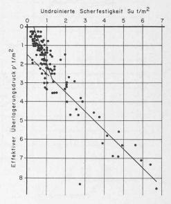
Bild 2. Drehflügelversuche in der Seekreide am Bielersee
