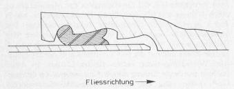
Bild 3. Lage der Rohrkupplungen zur Fliessrichtung während der Versuche
