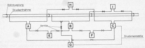
Bild 1. Messung des Druckverlustes. Anordnung der Druckzellen in einem Mehrfachkreislauf.
