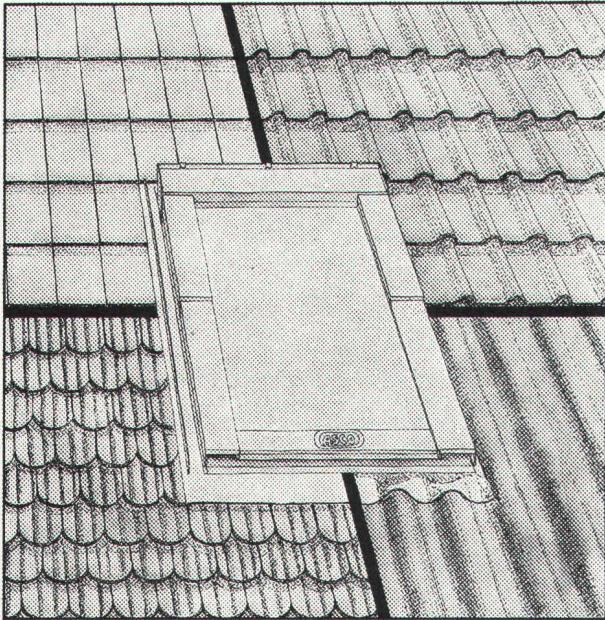
Sobald die Dachneigung 20° beträgt, können ASCO-Dachwohnraumfenster in praktisch jedes Dach eingebaut werden. Egal, wie das Dach gedeckt ist.
