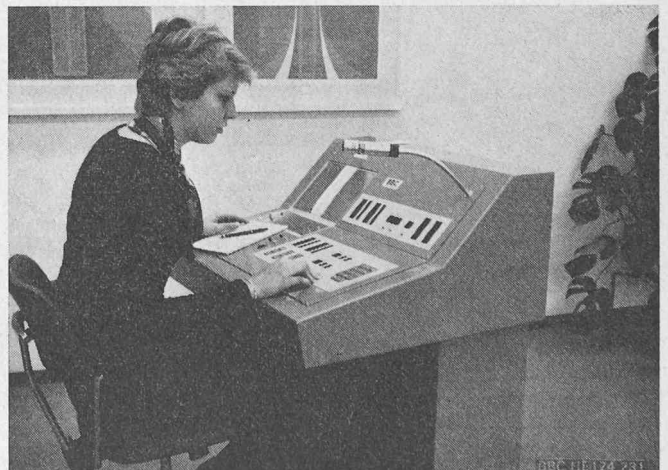
Mikroprozessorgesteuertes Einsatzleitsystem, Steuerpult
